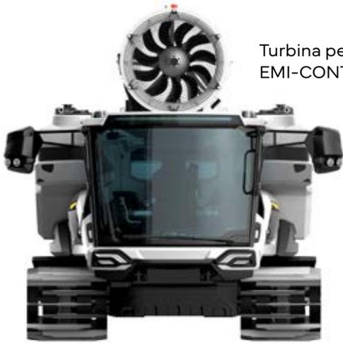
Turbina per l'abbattimento delle polveri
